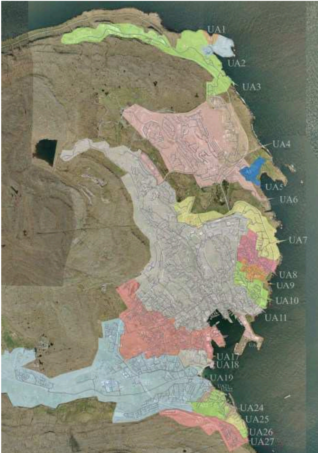
Mynd 2. Útlátsstöð fyrir reinsað spillivatn í Tórshavn. Økini, sum tey ymisku spillivatnsútlátini stava frá, eru merkt við ymiskum litum (Kelda: Tórshavn Kommuna 2015).
